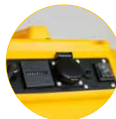
DFX 20 controlepaneel - urenteller, extra stroomaansluiting, 2 snelheden wisselaar.
