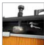
Grote paneelfilter met manuele filterreiniging
