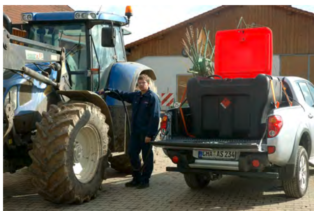
Adaptation des formes de la citerne pour permettre le passage de roue dans le pick-up De vorm van de tank is zo aangepast dat hij tussen de doorgang van de wielen past
